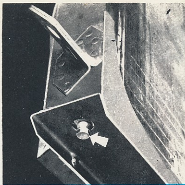
Bouchon de vidange d'eau du radiateur. 2
