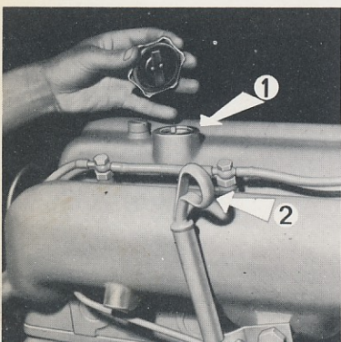
Orifice de remplissage d'huile et jauge de contrôle du niveau sur CSA. 5
