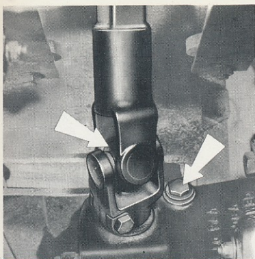
Boîtier de direction et cardan de commande sur CA PETITS TONNAGES.
