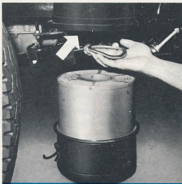
Remplacement du joint supérieur d'étanchéité du filtre à air.
