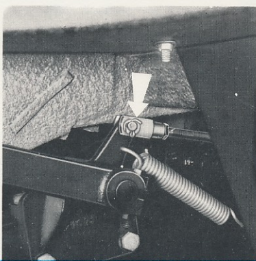
Commande de débrayage sur BIG JOB CSA (côté pédalier). 26
